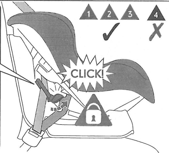
securing the harness, تأمين حزام الأمان , بستن كمر بند مهيار , attacher le harnais, feststellen des sicherheitsgurts, ασφάλιση των ζωνών ασφαλείας, mengamankan harness, 하네스 장착, 系好安全带, zapinanie pasów, como prender o suporte, крепление ремней безопасности, asegurar el arnés, การคาดเข็มขัด, güvenlik kemerinin bağlanması, таңғыш бауды мықтап байлау, cố định dây nịt
