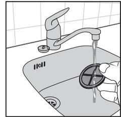
3 Αφήστε το φίλτρο να στεγνώσει εντελώς. Τοποθετήστε το ξανά στη βάση και κλείστε το κάλυμμα του φίλτρου.
