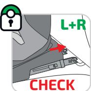
Veuillez vérifier avec les indicateurs de sécurité des DEUX CÔTÉS si le siège est correctement connecté aux deux ancrages ISOFIT (IA) de la voiture.
