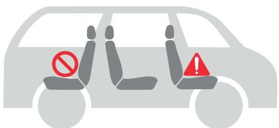
Für die Befestigung mit ISOFIX besteht eine „Semi Universale“ Genehmigung. Daher können Sie diesen Sitz nur in bestimmten Fahrzeugen nutzen. Die zugelassenen Fahrzeuge prüfen Sie bitte mithilfe der Typenliste. Eine aktuelle Liste finden Sie unter [www.h-germany.de](http://www.h-germany.de)
