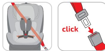
Passez la sangle diagonale de la ceinture de sécurité 3 points dans les guides de ceinture bleus à l'arrière du siège auto jusqu'à la boucle.
