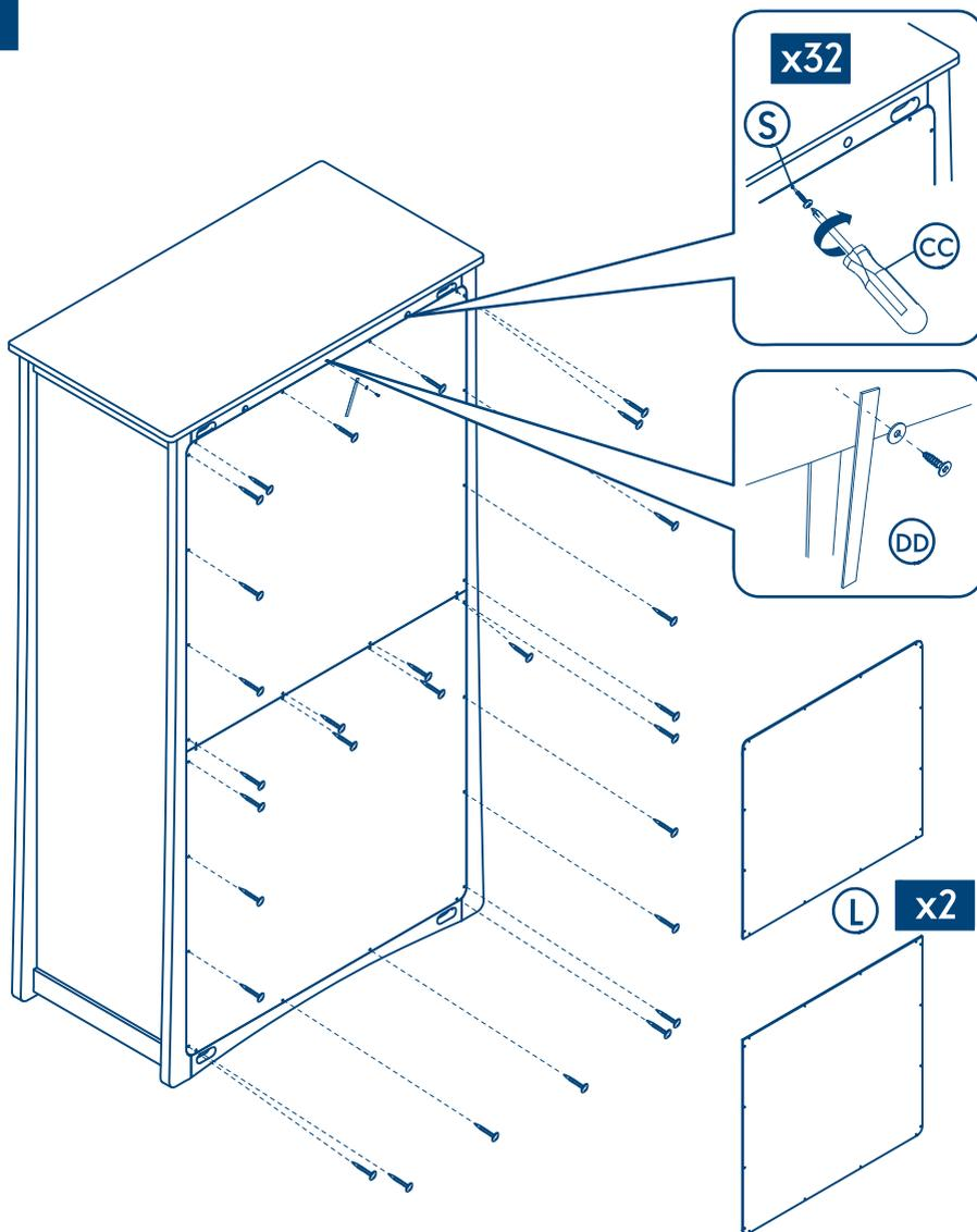
assembly instructions, إرشادات التجميع , دستورالعمل نصب قطعات , instructions de montage, montageanweisungen, οδηγίες για τη συναρμολόγηση, instruksi perakitan, 組み立て説明書, 조립 설명서 组装说明 , instrukcja montażu, instruções para montagem, инструкции по сборке, instrucciones de montaje, คำแนะนำสำหรับการประกอบ, kurulum talimatları
