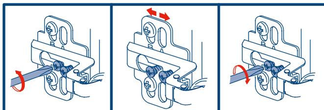
Door alignment adjustment, تنظیمات میزان سازی در, ضبط محاذة الباب, Réglage de l'alignement de la porte, Einstellvorrichtung für Türpassung, Ρύθμιση ευθυγράμμισης πόρτας, Penyesuaian penyelarasan pintu, ドア位置合わせ調節, 도어 정렬 조정, 门对齐调整, Dostosowanie linii drzwi, Ajuste do alinhamento da porta, Регулировка дверцы, Ajuste de la alineación de la puerta, การปรับตำแหน่งประตู, Kapı hizalama ayarlaması
