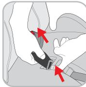
Jetzt können Sie das 5-Punkt-Gurtsystem vollständig entfernen. Den Zentralverstellgurt (G5) verstauen Sie unter der Einstellerabdeckung (F).
