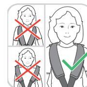
Для того, чтобы отрегулировать высоту подголовника (A) в соответствии с ростом и весом ребенка, возьмитесь за подголовник сверху и потяните за кнопку механизма регулировки подголовника по высоте (H). В соответствии с ростом и весом
