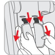
Теперь Вы можете снять плечевые ляжки ремней (G2) и плечевые накладки (SG) с механизма регулировки по высоте и вытянуть ляжки из пазов спинки (G1).
