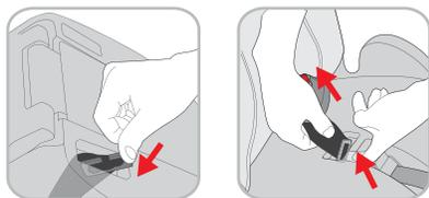
Для того, чтобы снять центральную ляжку ремня безопасности, пропустите удерживающую ее металлическую пластину через соответствующее ей отверстие на дне сидения.
