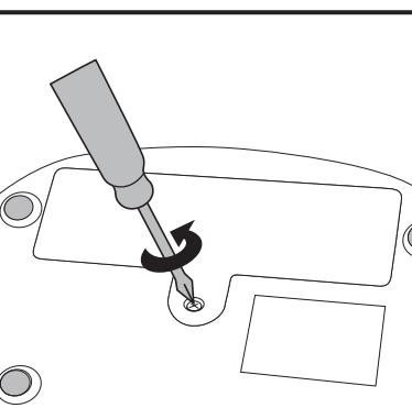
**(id)** Letakkan unit kontrol menghadap ke bawah pada permukaan rata. Buka tutup tempat baterai menggunakan obeng. Masukkan 4 baterai "AA" (LR6) atau baterai alkalin yang setara (tidak disertakan) ke dalam tempat baterai. Pasang kembali penutup baterai.
