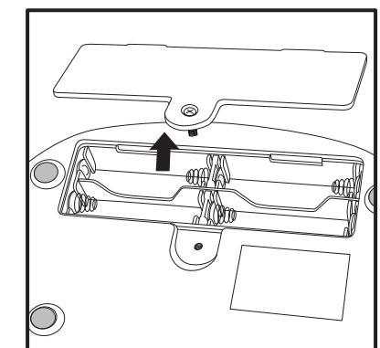
**(pt)** Posicione a unidade de controle com a face para baixo numa superfície plana. Abra a tampa do compartimento de pilhas com uma chave de fenda. Insira quatro pilhas alcalinas "AA" (LR6) ou equivalentes (não inclusas) no compartimento de pilhas. Feche a tampa do compartimento.
